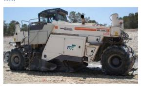
Mezclador de suspensión Wirtgen WM-1000 de 165 kW con un silo de cemento de 25 m<sup>3</sup> y un depósito de agua, de 11.000 l.
